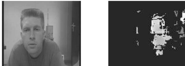
Figure 20 : Un objet situé devant le plan est détecté par le système car sa disparité est de signe négatif.
