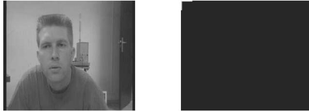
Figure 19 : Un objet situé derrière le plan n'est pas détecté par le système car sa disparité est de signe positif.
