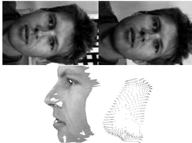
Figure 8 : Un exemple de stéréogramme croisé (en haut), la reconstruction obtenue à partir de ce stéréogramme, et le champ de normales obtenus par notre méthode de corrélation sur le nez.
