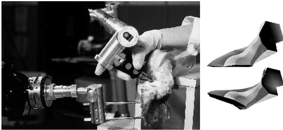
Figure 3: Saisie de données et simulation des déformations du ligament.
