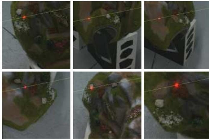
FIG. 7 – *La tâche engendrée par un pointeur laser rigidement lié à une caméra est contrainte à se déplacer sur une droite épipolaire laser.*
