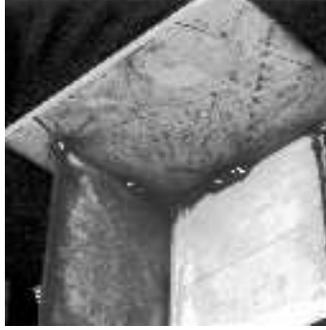
FIG. 6 – *Un trièdre orthogonal, pièce de navire à souder.*
