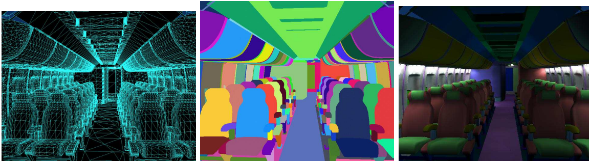
FIG. 1 – clustering dans une scène complexe: (a) ensemble de triangles composant la scène (b) regroupement topologique (c) résultat de la simulation par radiosity.
