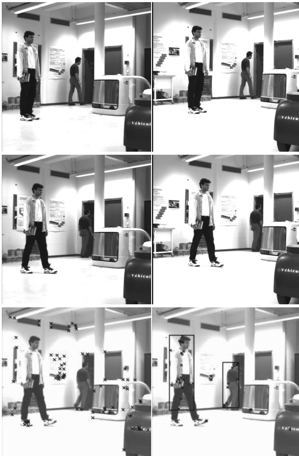
FIG. 2 – Un capteur stéréoscopique observe plusieurs objets en mouvement alors qu’il bouge lui-même. Sur cette figure on peut voir deux paires d’images extraites d’une séquence de 10 paires d’images, les points extraits de la scène statique (en bas à gauche) ainsi que les deux objets en mouvement (en bas à droite).
