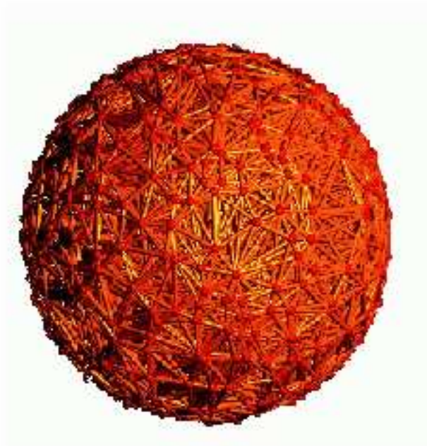
FIG. 7 – Triangulation de Delaunay tridimensionnelle calculée par la bibliothèque CGAL
