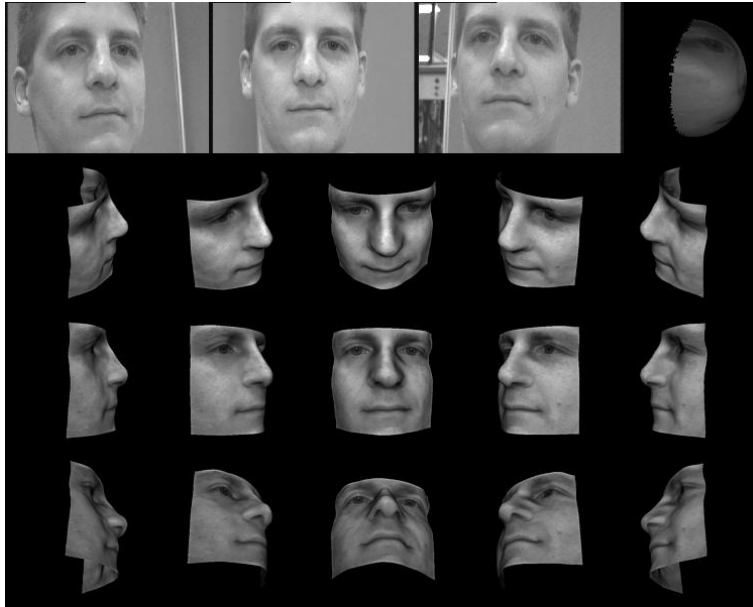
FIG. 8 – Les trois images en haut à gauche ont été prises simultanément de différents points de vue. L'image en haut à droite montre la surface initiale (une sphère) et les trois images sont projetées dessus. La reconstruction est obtenue en déformant cette surface de façon à satisfaire l'équation aux dérivées partielles associée au problème variationnel. Les 15 autres images montrent la reconstruction résultante de plusieurs points de vue.
