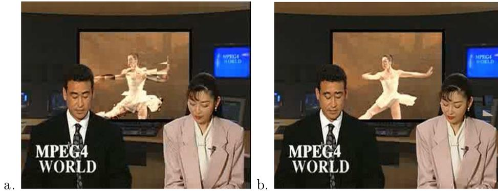
FIG. 8 – Codage vidéo robuste: (a) image de la séquence news codée par l'algorithme H.263 version 2, en présence de pertes sur le réseau; (b) image de la séquence "news" codée avec algorithme de choix de modes adaptatif aux caractéristiques du réseau
