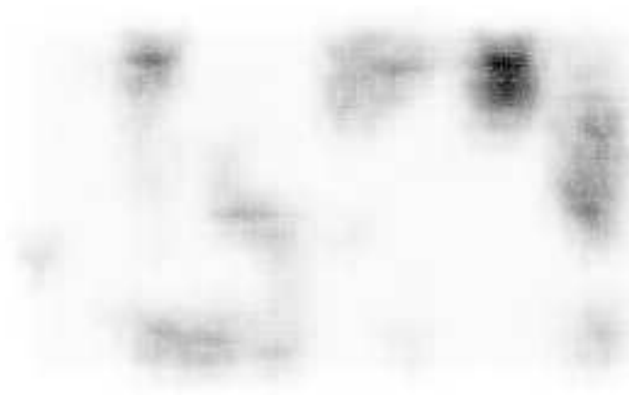
FIG. 12 – Intensité d’usage des pixels lors du traitement de la scène de la figure 11. Les zones sombres indiquent où un grand nombre de détecteurs a été utilisé.
