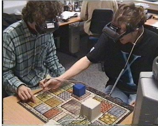
FIG. 16 – Deux utilisateurs interagissent avec des éléments virtuels affichés sur le plateau de jeu. Ils sont équipés de casques et interagissent à l'aide de stylo (les 2 éléments sont suivi grâce à l'utilisation de capteurs).
