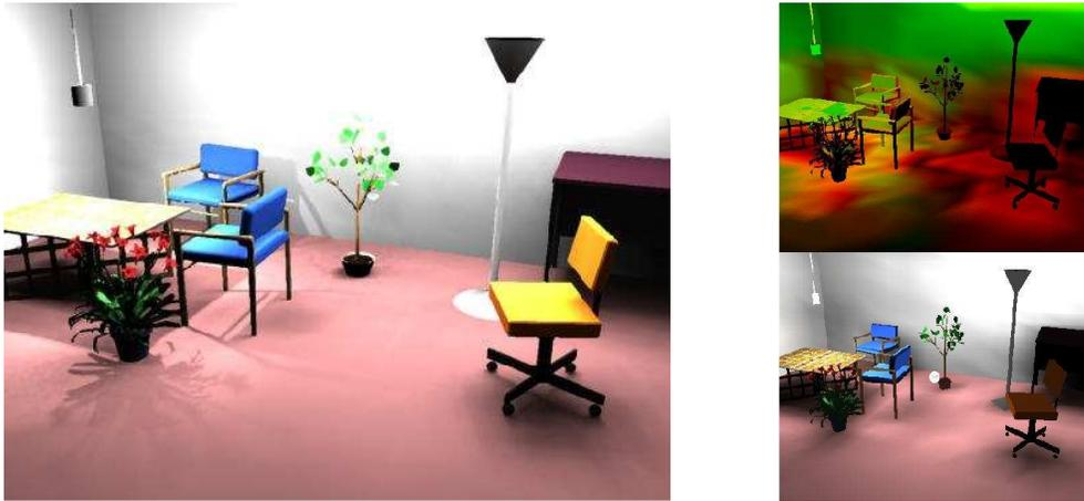
FIG. 8 – A gauche l'image finale, à droite (haut) un codage fausse couleur (plus rouge signifie plus de calcul, en particulier dans les zones d'ombre), à droite (bas) la visualisation de la solution de radiosity directe. La différence de qualité est évidente.
