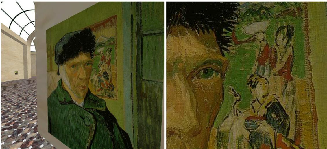
Figure 5. A gauche : image rendue à l'aide de l'allocation automatique de charge sur les textures. Les textures au fond du musée sont en niveau bas tandis que la plus proche est en très haute résolution. Les textures d'origine sont en 1024x1024x24bits. La plate-forme affiche 23 images par secondes. Sans l'optimisation, la plate-forme affiche 2 images par secondes. A droite : vue rapprochée du tableau, toujours à 23 images par secondes.
