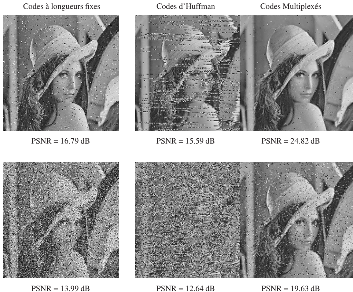
Figure 8. PSNR et qualité visuelle obtenus respectivement avec codes à longueurs fixes, codes d'Huffman et codes multiplexés. Les taux d'erreurs bits sont 0.005 (en haut) et 0.05 (en bas).
