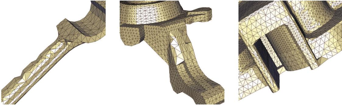
Figure 9. Objets améliorables. Dans ces trois cas, on a l'illustration d'une reconstruction ayant fait, localement, quelques mauvais choix. Il manque quelques faces (cas concave, pas assez de matière) ou, au contraire, on a des faces à supprimer (cas convexe, trop de matière).
